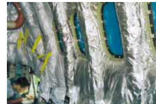
Hält warm: Im Passagierraum werden 350 Kubikmeter feuerfeste, ungiftige Isolation ersetzt.
