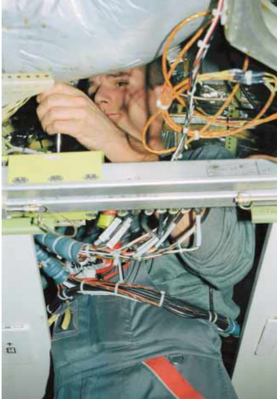
Kabelsalat: Ein Arbeiter prüft die Elektrik an der Decke des Passagierraums.
