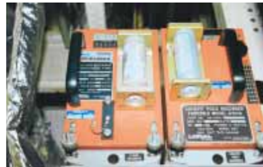
Jet-Gedächtnis: Die Blackbox im Frachtraum. Links der Flugschreiber, rechts der Voicerecorder.
