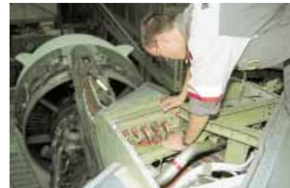
Prüfender Blick: Kontrolle der Triebwerkaufhängung.
